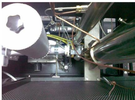
Dettaglio del gruppo compressore-turbina
